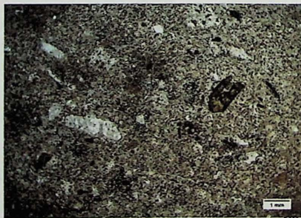
Fotomicrografia 20. Tinguaito com fenocristais. Amostras T-295. Em destaque fenocristais de feldspato alcalino e clinopiroxênio. Nicóis paralelos.
