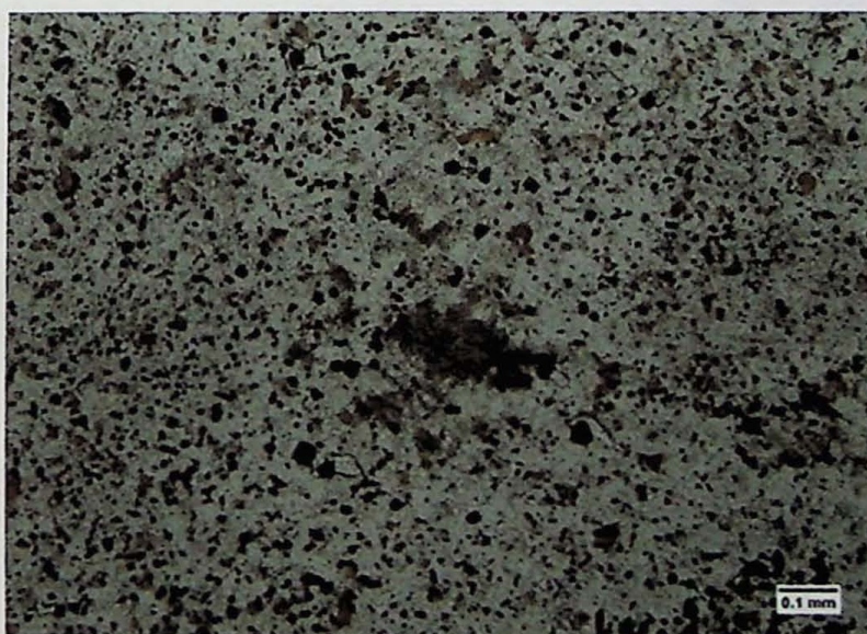
Fotomicrografia 18 - Tinguaito com astrofilita. Amostra T-228. Minerais granulares de coloração alaranjada são provavelmente astrofilita. Destaque para mineral incolor na forma de agregado na porção central da imagem, possivelmente catapleita. Nicóis paralelos.
