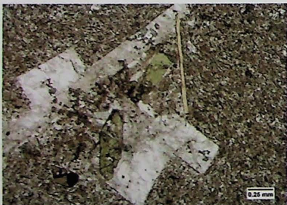
Fotomicrografia 19 – Tinguaito com fenocristais. Amostra T-1. Em destaque fenocristais de feldspato alcalino, clinopiroxênio, biotita e titanita. Nicóis paralelos.
